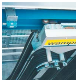
Angetriebener Großleitungswagen mit Magnetschalter zur landseitigen Endabschaltung
