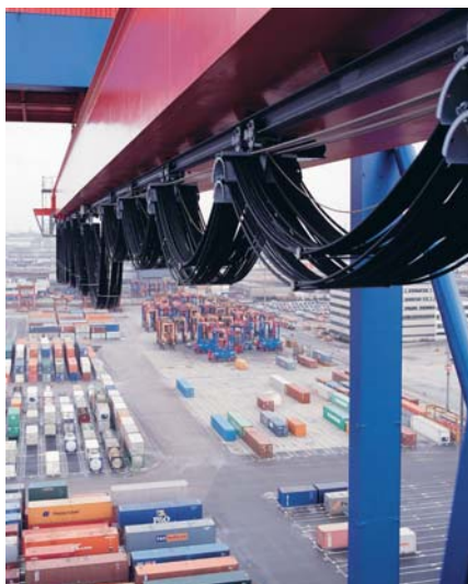
Schwer bepackt! Angetriebenes Leitungswagen-System Programm 0380 in Kombination mit Programm 0375 auf einem STS-Containerkran.
