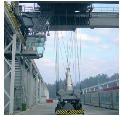
Federleitungstrommel Stock & Go auf einem Spreader
