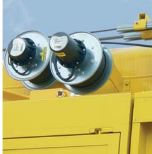
Federleitungstrommeln Stock & Go auf einem schienenge- bundenen Mobilkran
