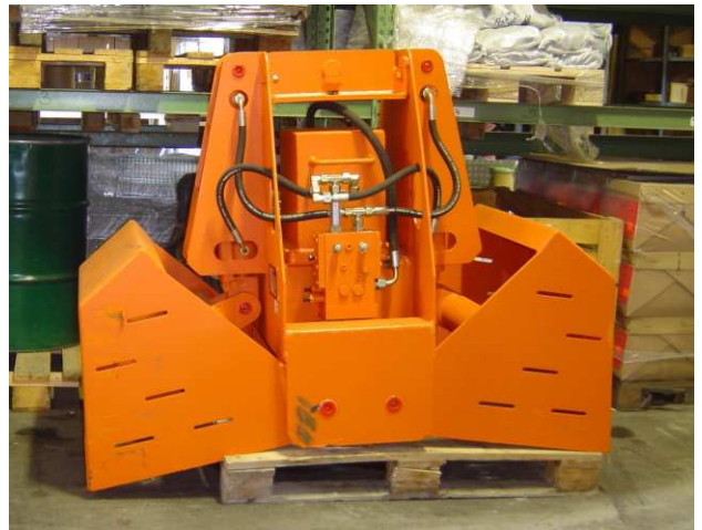
0,33 m 3 motoros markoló szállítása, vízalatti üzemre
