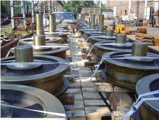
Előszerezelt, súllyesztékben kovácsolt darukerekek szállítása
