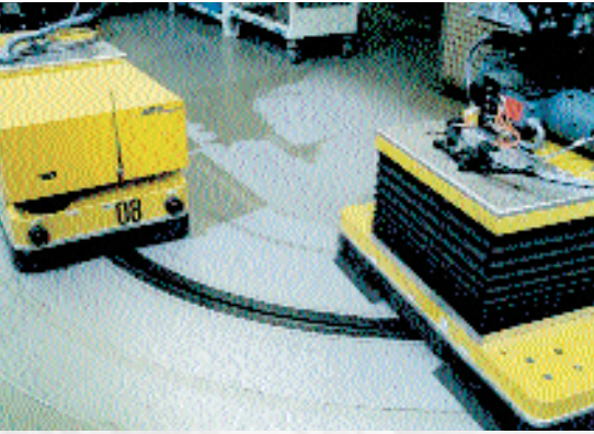
Szállítórendszer a padlószinten induktív energia ellátással
