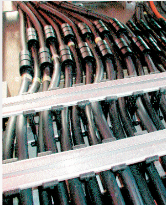
Vezetékek SZL húzásmentesítős energiavezető láncokhoz
