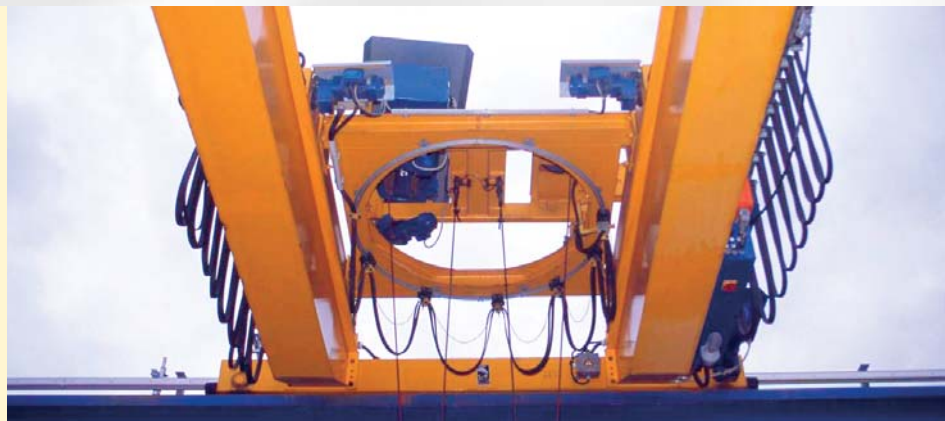
Flexibilis áram-hozzávezetések, egyenes vonalúak és kör alakúak
