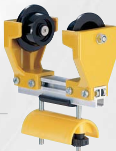
Kábelkocsik négyélű sínekhez Terhelhetőség 36 kg-ig, különösen alkalmas kör alakú és íves pályákhoz
