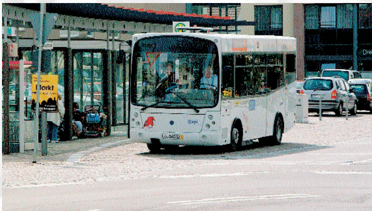
Villamos városi busz érintkezés nélküli akkumulátor töltéssel
