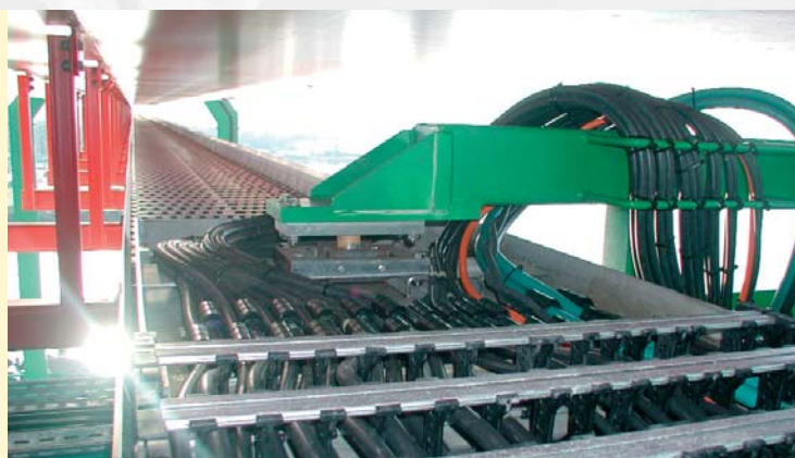
Energiaevezető lánc nagy elmozdulási úthosszal egy Ship-to-Shore konténerdarun
