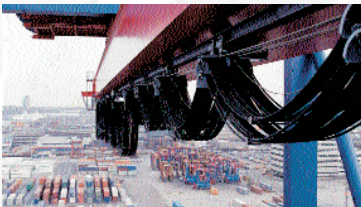
Meghajtott kábelkocsi rendszer egy ship-to-shore (STS azaz hajóból partra) konténerdarunál
