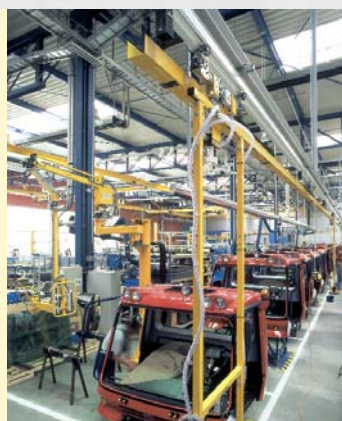
Közeg ellátás W 4 -airsolution segítségével haszonjárművek gyártásánál
