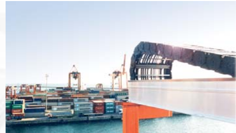
Cobra energiaevezető lánc rakásoló darun
