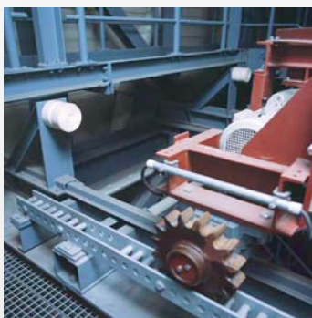
Véghelyzeti csillapítás emelődarura szerelve
