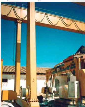
Rugós kábeldob egy híd darun
