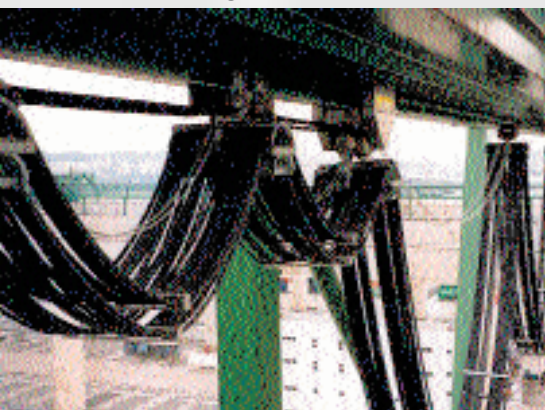
Energia és vezérlő vezetékek konténerdarun
