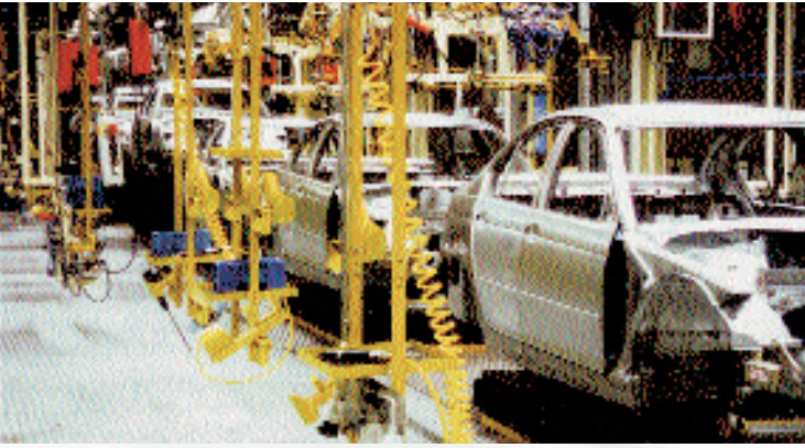
Közeg betáplálás és szerszámszállító kocsik az autógyárban
